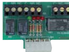
ACQ9081 TARJETA 3 RELÉ para administrar una lámpara de cortesía, un semáforo o un bloqueo electromagnético
