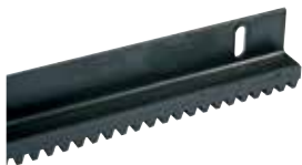
ACS9040 CREMALLERA M4 de acero (sec. 22 x 22 mm) con angular 45 x 30 mm (hasta 4.000 Kg) en barras de 2 m al m
