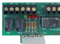
ACQ9081 TARJETA 3 RELÉ para P1 para administrar una lámpara de cortesía, un semáforo o un bloqueo electromagnético
