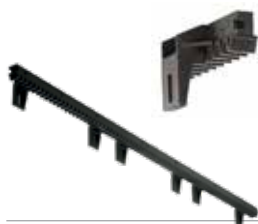
ACS9026 Cremagliera M4 in Nylon con barra interna di acciaio. (sez. 28 x 40 mm). Con 6 attacchi rivolti verso il basso (fino a 800 Kg). in barre da 1 m al m 27 €
