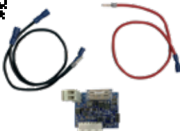
ACG4774 CARICA BATTERIE per P1 24V-CRX Gestisce 2 batterie ACG9511 (o fino a 12 Ah ciascuna) e può essere collegato a "regolatore di carica solare" modello SOLSUM 10.10F della STECA con 1 pannello solare da 24V 100 W (o 2 da 12V 50 W collegati in serie)
