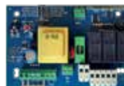
ABJ8042 R-CRX 2.0 quadro per 1 BOY. Con ricevitore 433 MHz incorporato. Con contenitore IP55. Vedere pag. 139 e 145
