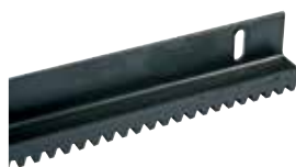
ACS9040 CREMAGLIERA M4 in metallo (sez. 22 x 22 mm) con angolare 45x30mm (fino a 4000 kg)
