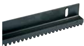
ACS9050 CREMAGLIERA M4 in metallo (sez. 22 x 22 mm) rivestita con CATAFORESI, con angolare 45x30mm (fino a 4000 kg)
