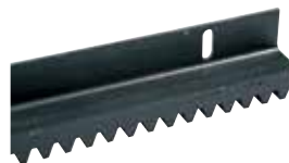
ACG9080 CREMAGLIERA M6 in metallo da trattare (sez. 30 x 30 mm) con angolare 45x45 mm in barre da 2 m
