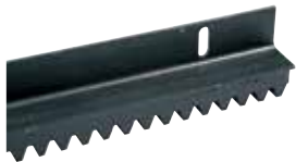
ACG9090 CREMAGLIERA M6 in metallo (sez. 30 x 30 mm) rivestita con CATAFORESI, con angolare 45x45 mm in barre da 2 m
