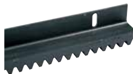
ACS9080 CREMAGLIERA M6 in ferro (sez. 30 x 30 mm) con angolare 45x45 mm
