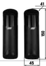
ACG8046 NOVA (no/nc) portata segnale infrarosso 15÷40m - ottica 180° sincronismo fino a 4 coppie gestisce 2 coste no/nc 8.2KΩ IP44 - 12/24V ac/dc
