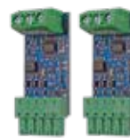
АС68081 Карты для синхронизации 2 команд RAPID и устройств безопасности. Синхронизация может быть активирована только с помощью приложения RIB GATE.
