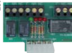
АСQ9081 3 Релейная карта для управления светом, светофором, электромагнитным замком с P1-CRX
