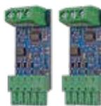
ACG8081 Карты для синхронизации 2 команд RAPID и устройств безопасности. Синхронизация может быть активирована только с помощью приложения RIB GATE.
