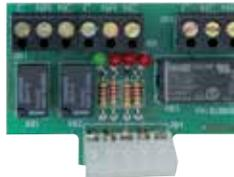
ACQ9081 3 Релейная карта для управления светом, светофором, электромагнитным замком с P1-CRX
