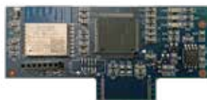
APP8064 2,4 ГГц IEEE 802.11 b/g/n Wi-Fi модуль со встроенной антенной - для карты APP + управлять панелью управления через локальную сеть Wi-Fi (WLAN)
